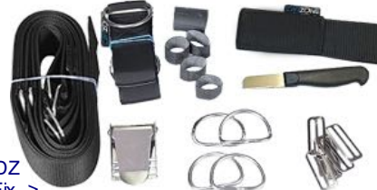
56303 on yleisin vakioremelistö. Sis. 4m erittäin jäykkä hihna jossa reikä ja purjereingas, 1.5m haarahihna, 2x D-rengas, 3x taivutettu D-rengas, 7x Stoppari, vyön solki, kumirenksuja, puukko.
