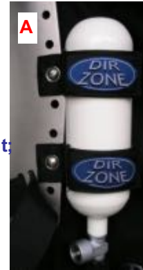
Kuvassa on 1,5L säiliö, alentaja, ylipaineventtiili, nappimittari, Miflex letku. Alentajassa (HL406) on 2x MP ja 1 HP lähtö.
