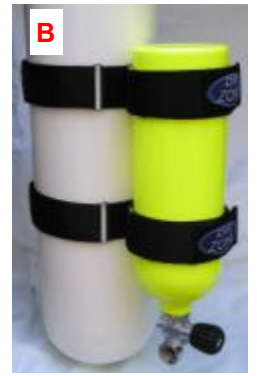
Kuvassa on 1,5L säiliö, alentaja, ylipaineventtiili, nappimittari, Miflex letku. Alentajassa (HL406) on 2x MP ja 1 HP lähtö.
