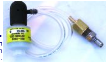
181 Flow Restrictor -> kaasujen analysointiin kompressorin painepuolelta.
