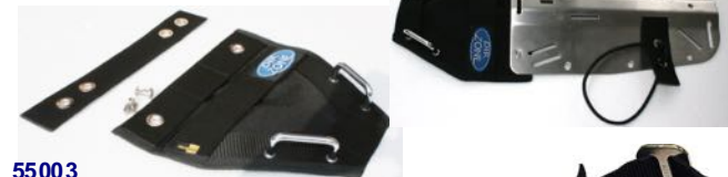
55003 Sidemount Back Pad. Käytetään pullon rigaukseen sidemount -tyyliin. Pullo kiipsataan kiinni kahvaan, ja bungeelenkki venttiin nupin ympärille. Pullo on nättisti kinalossa, virtaviivaisesti sukeltajan sivulla.
